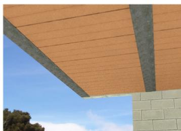
**IMPORTANTE:** Para la elaboración de voladizos en el sistema Perfil Placa Acerfo, es necesario colocar **doble malla electrosoldada** sobre el área del voladizo, la cual se extenderá en la placa el doble de la luz del voladizo.
