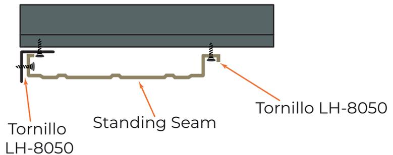
3. Fijación interna entre bandejas standing seam con tornillo LH-8050.
