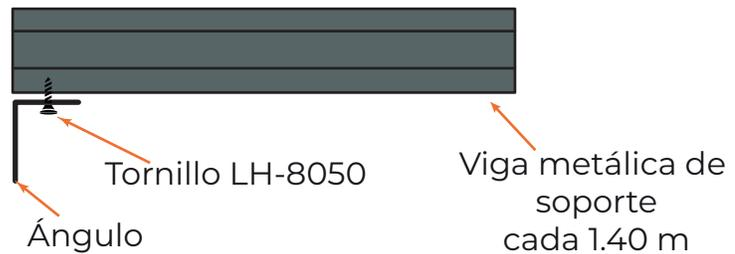
2. Fijación bandeja standing seam a viga de soporte con tornillo LH-8050.
