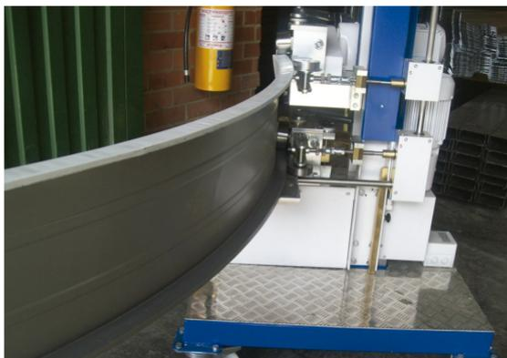
Las cubiertas curvas en este tipo de teja se deben manejar con flechas no mayores a 0,60 cm en longitudes de apoyo de 6m ya que por los rigidizadores laterales que se tienen en el momento de grafado presentan efectos de tensión y compresión en la zona plana de la teja produciendo efectos visuales de mal aspecto estético.
