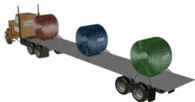
Cuando realice descargue con grúa coloque protectores a cada lado del rollo para que el cable de la grúa no dañe la lámina.
